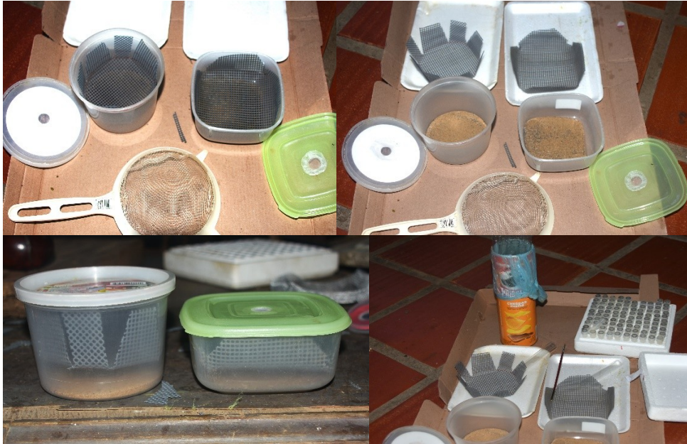
Figura 3. Alternativas de contenedores de muestras de órganos de plantas infestados por P. longifila utilizando malla plástica como sostenedor de muestra.
